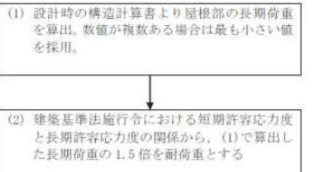
図1 許容堆積荷重算定フロー
