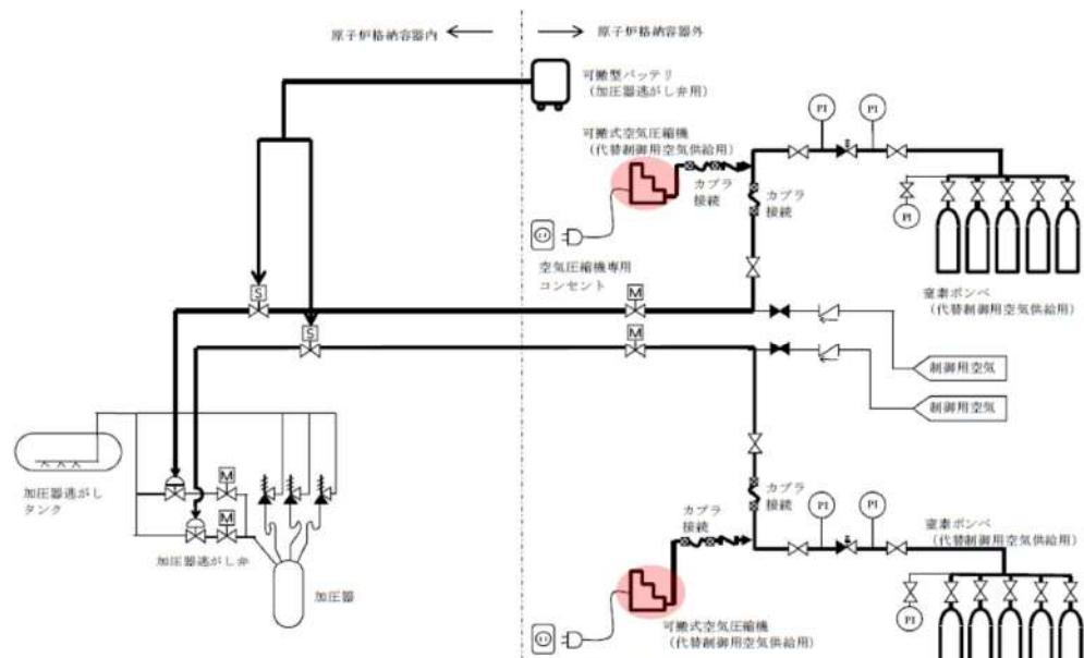
第 5.5.7 図 原子炉冷却材圧力バウンダリを減圧するための設備 概略系統図 (7)
