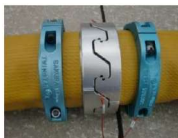
可搬型ホース（150A）接続後
