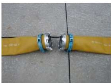
可搬型ホース（150A）接続前
