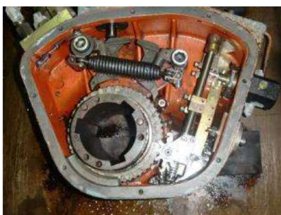
蒸気暴露試験後
