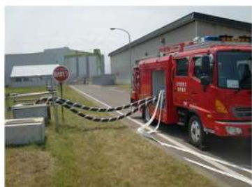
可搬型大型送水ポンプ車の設置 原水槽への吸管挿入 (屋外 T. P. 10. 3m)
