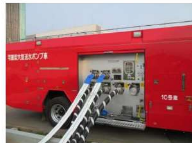
可搬型大型送水ポンプ車 周辺のホース敷設 (屋外 T. P. 33. 1m)
