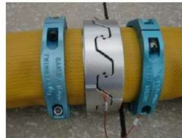
可搬型ホース (150A) 接続後
