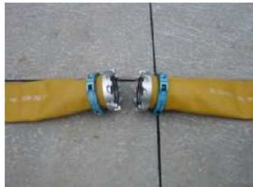
可搬型ホース (150A) 接続前
