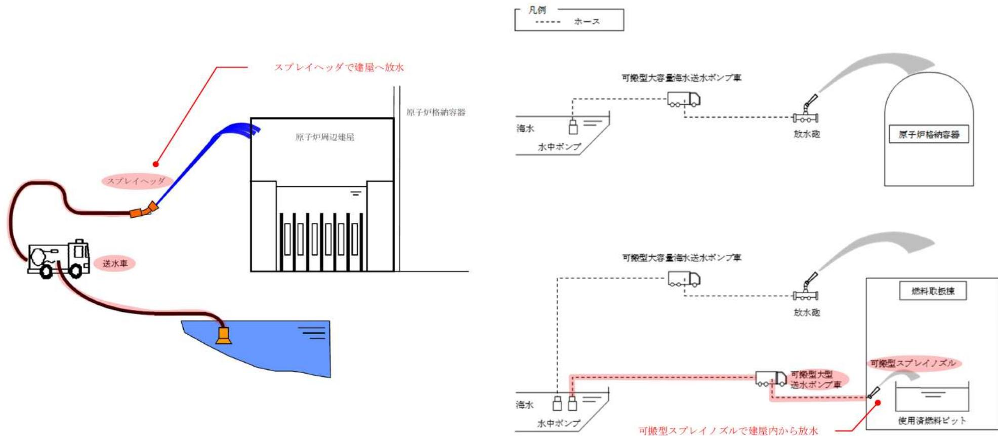
大飯3／4号炉 スプレイヘッダを用いた大気への拡散抑制
