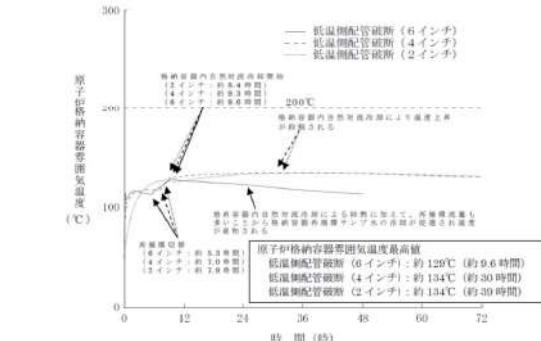
第 2.4.3.2 図 原子炉格納容器雰囲気温度の推移（破断口径の影響確認）
