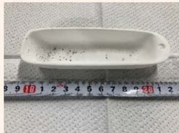
試験後 (1000°C水蒸気環境下)
