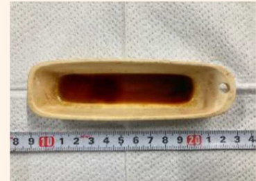
試験後 (200°C水蒸気環境下)
