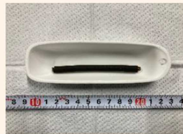
試験後 (200°C水蒸気環境下)
