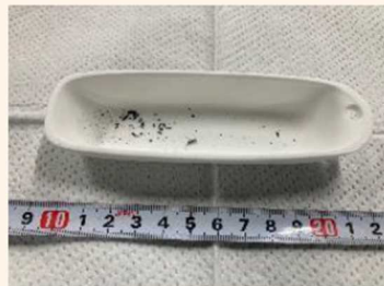
試験後 (1000°C水蒸気環境下)
