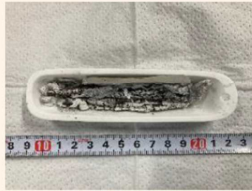
試験後 (1000°C水蒸気環境下)
