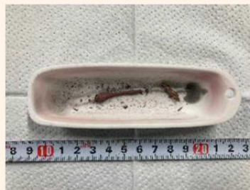
試験後 (1000°C水蒸気環境下)
