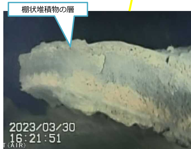
写真3. ペDESTAL外棚状堆積物断面
