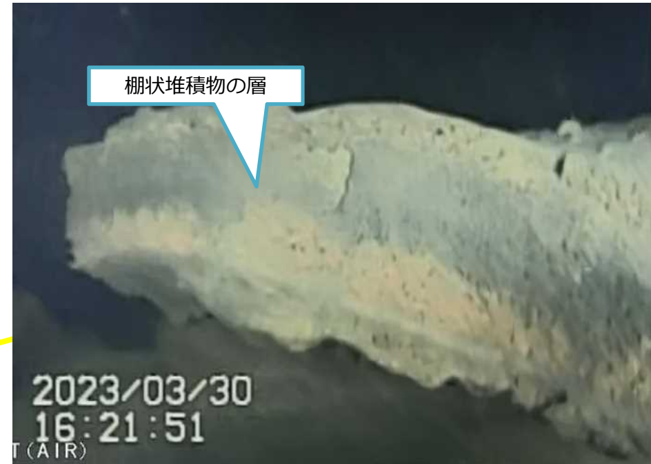
写真1. ペDESTAL外棚状堆積物断面
