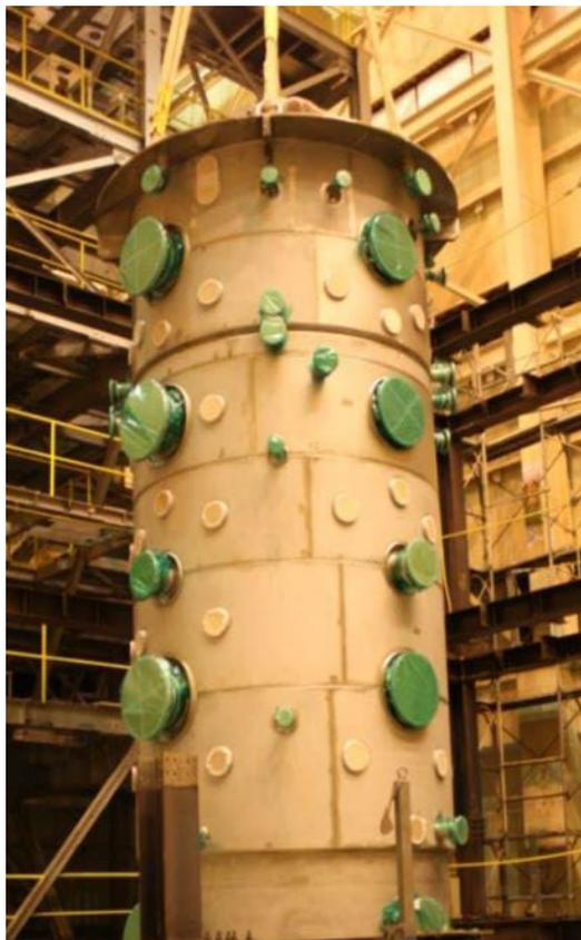
様々な箇所から蒸気-空気-ヘリウム混合の高温気体 (~ 700 °C) を注入
