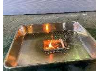
潤滑油 + コンクリート片炙り
