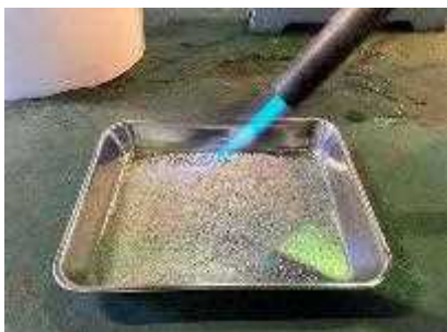
コンクリート片炙り ・炎なし
