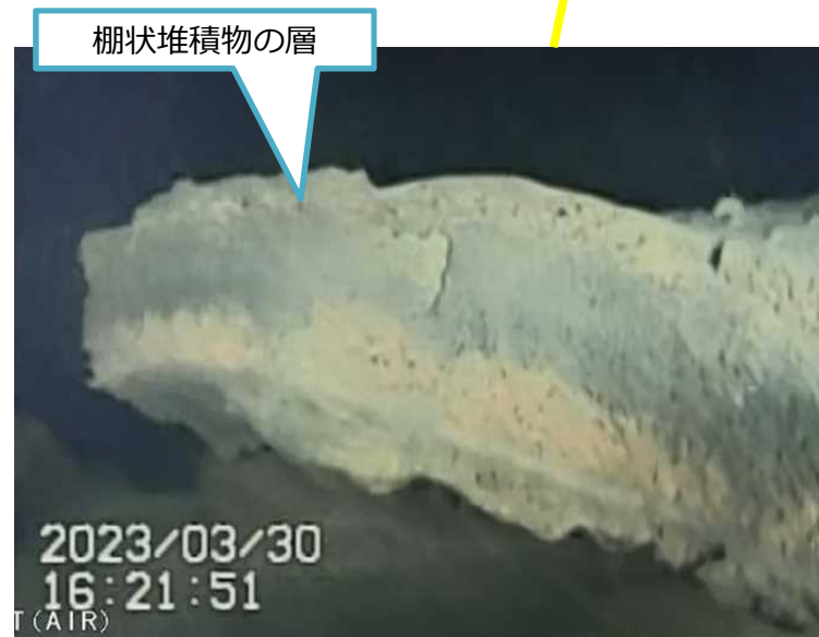
写真3. ペDESTAL外棚状堆積物断面
