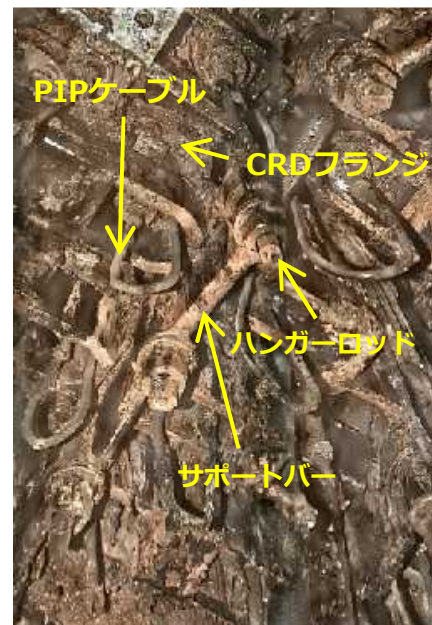
写真2. 2号機で確認されたCRD
