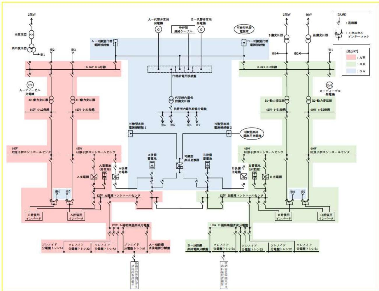
第2図 電源構成図 (直流電源)
