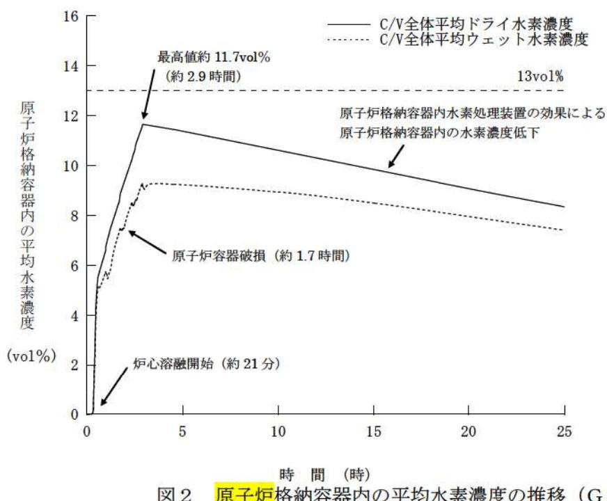
図 2 原子炉格納容器内の平均水素濃度の推移 (GOTHIC)
