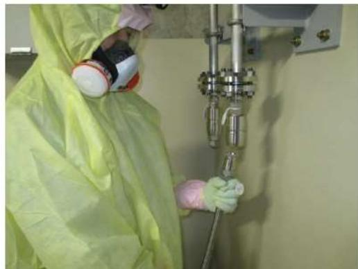
可搬型格納容器内水素濃度計測ネット接続
