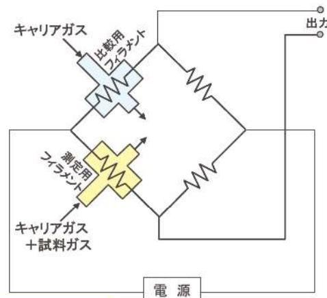
図1 ガス分析計（ガスクロマトグラフ）の測定原理
