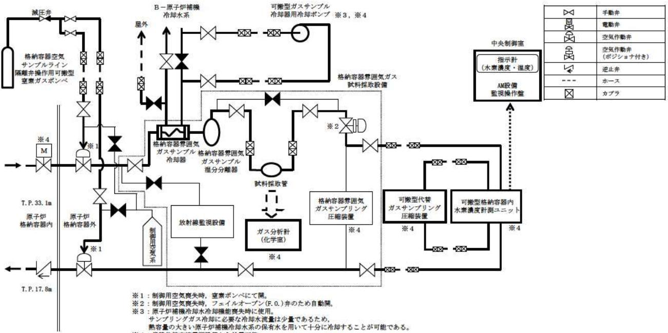
図8 格納容器界囲気ガス試料採取設備の系統(手分析時)
