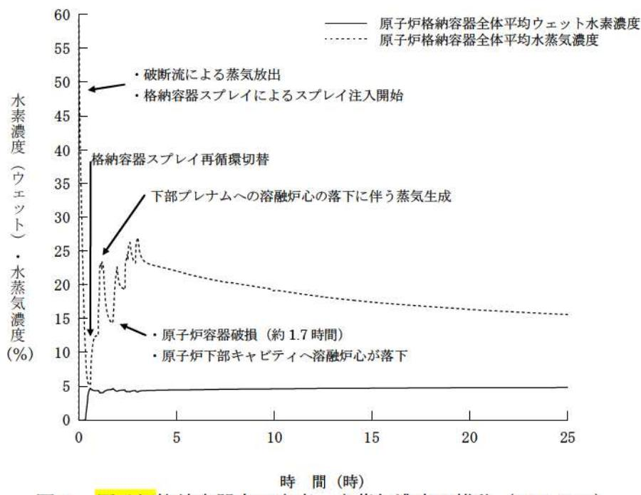
図 1 原子炉格納容器内の水素・水蒸気濃度の推移 (MAAP)
