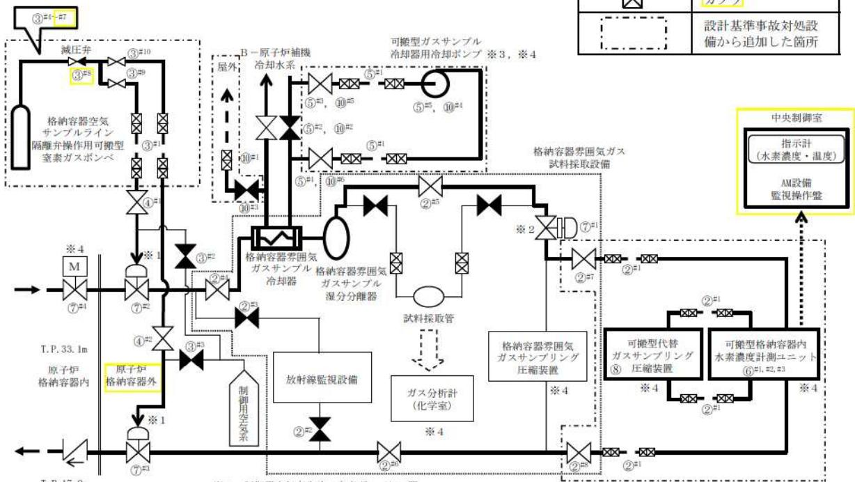
第 1.9.7 図 可搬型格納容器内水素濃度計測ユニットによる原子炉格納容器内の水素濃度監視（全交流動力電源及び原子炉補機冷却機能が喪失した場合） 概要図 (1/3)
