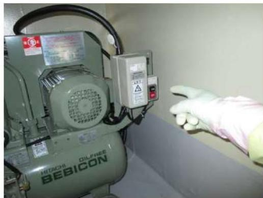
可搬型代替ガスサンプリング圧縮装置起動
