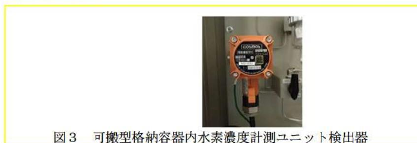
図3 可搬型格納容器内水素濃度計測ユニット検出器
