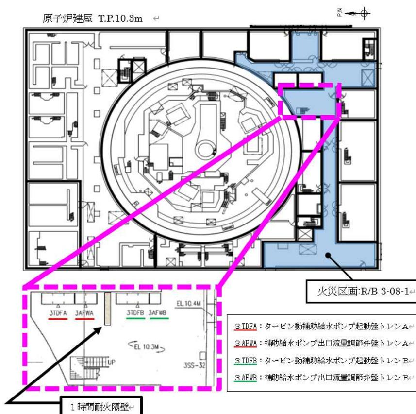
第3図：火災防護対象機器（制御盤）の系統分離対策の概要
