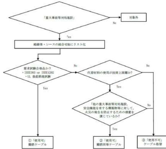
第1図：難燃性ケーブル確認方法
