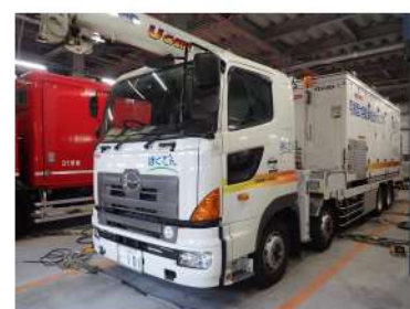
可搬型大容量 海水送水ポンプ車
