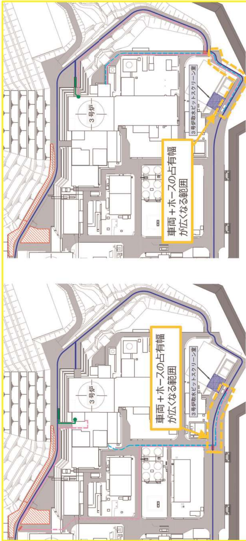
3号炉原子炉建屋西側を経由したルートを選定した場合
