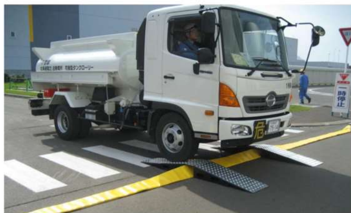
第1図 ホースブリッジの設置状況
