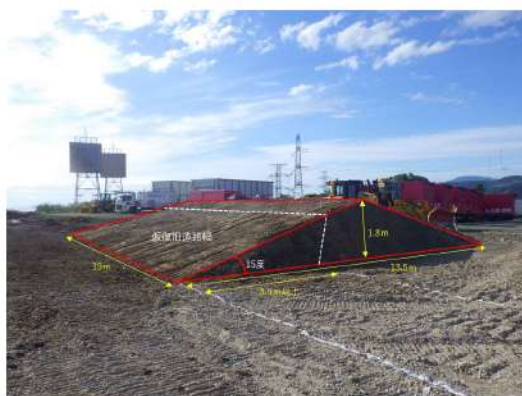
第3図 斜面崩壊後を模擬した土砂
