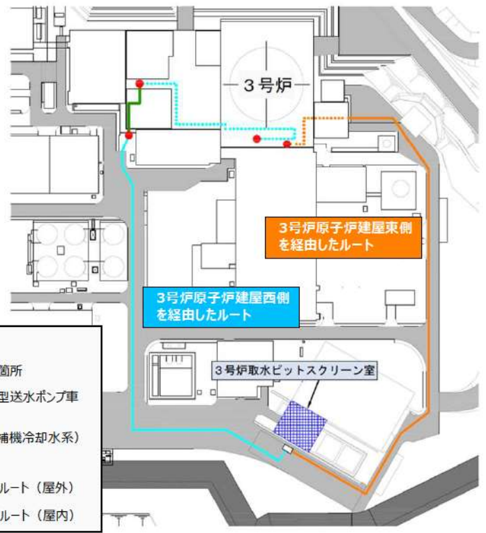
図2 原子炉補機冷却水系への通水確保（海水）の概略図
