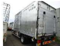
大規模損壊対応用変圧器車
