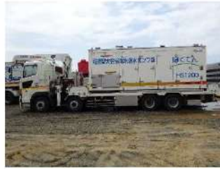
可搬型大容量海水送水ポンプ車
