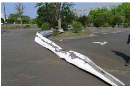
飛散した鋼板製屋根材
