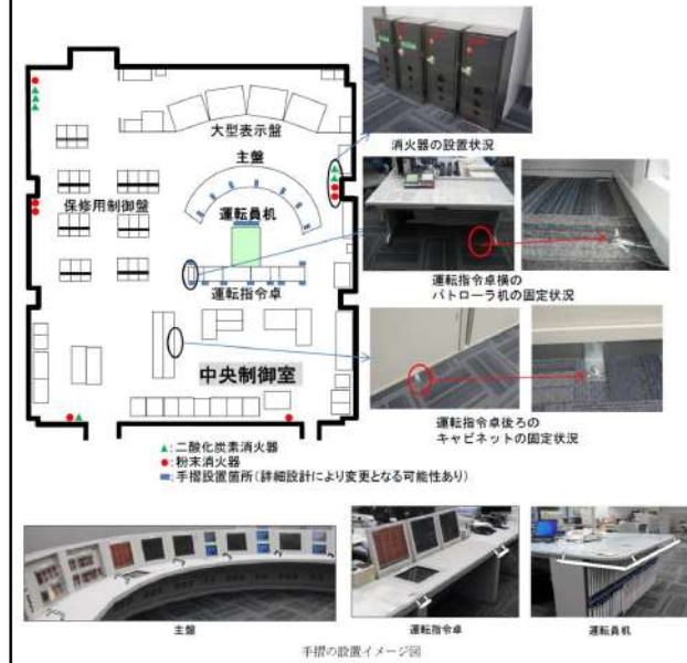
図 2.4.2 中央制御室における消火器の設置状況、キャビネット等の固定状況及び手摺の設置イメージ
