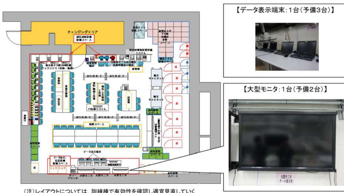
参考第 5-1 図 緊急時対策所における SPDS パラメータ表示の概要
