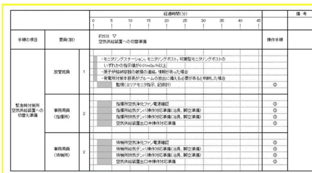
図2.18-8 空気供給装置（空気ポンプ）への切替準備 タイムチャート*
