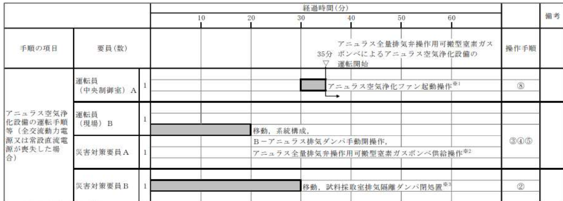
図2.16-5 アニュラス空気浄化設備の運転手順等 タイムチャート* (全交流動力電源又は直流電源が喪失した場合)
