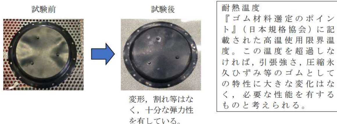
図2 試験前後のダイヤフラムの状態
