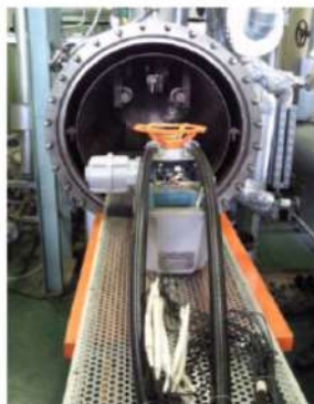
図2 蒸気曝露試験装置
