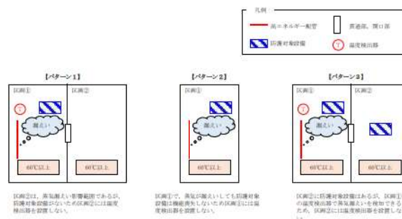
図2 区画配置温度検出器設置概念図
