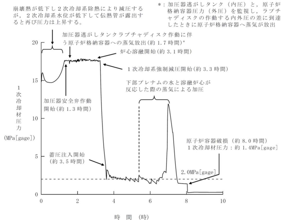
図 1次冷却材圧力の推移 [7.2.2-29]
