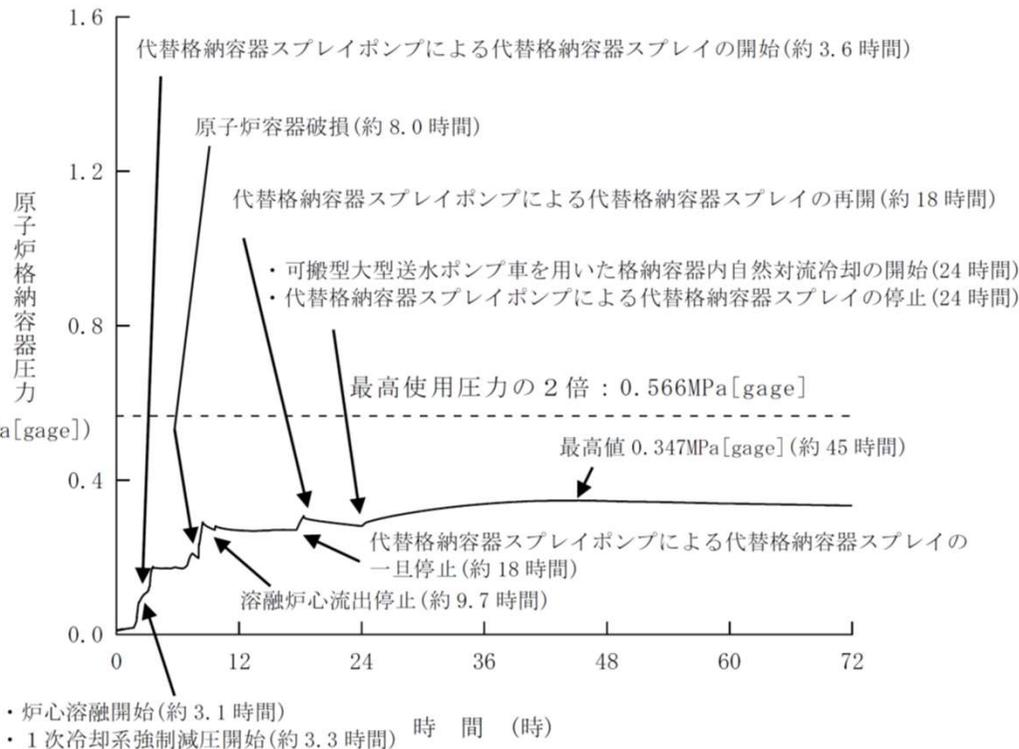
図 原子炉格納容器圧力の推移 [7.2.1.2-54]
