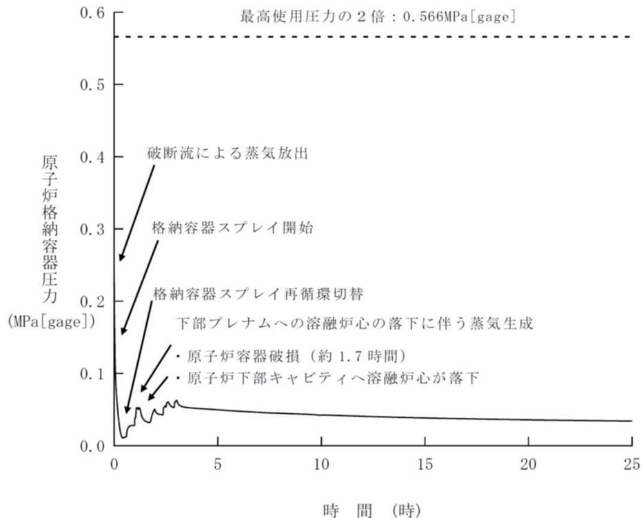
図 原子炉格納容器圧力の推移 [7.2.4-49]
