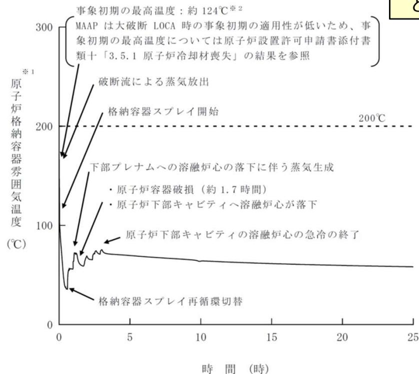
※1: 原子炉格納容器雰囲気温度の推移はMAAPによる解析結果を示している
