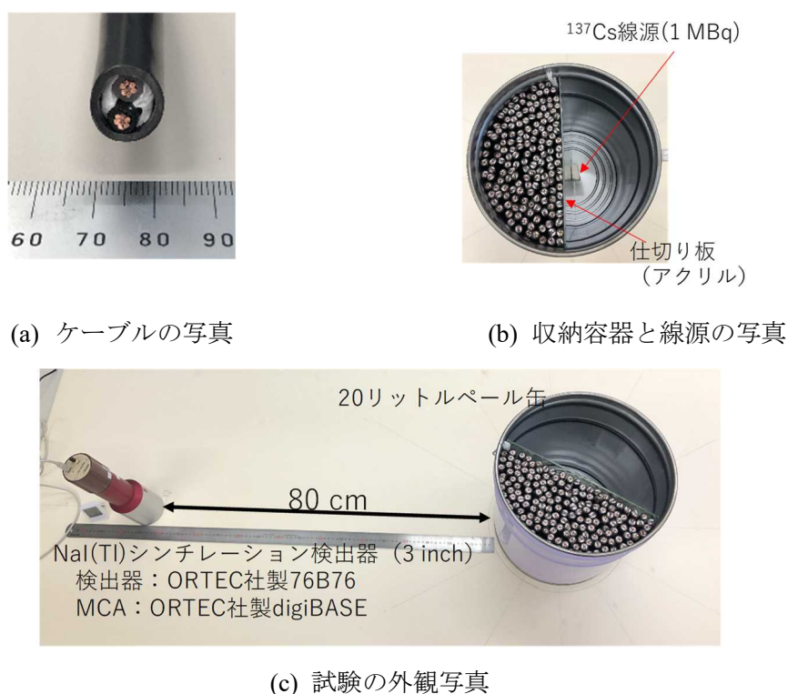
図 5.2.4 ケーブルを収納した収納容器の放射線計測試験 (成果発表リスト5. に示す発表資料からの抜粋)
