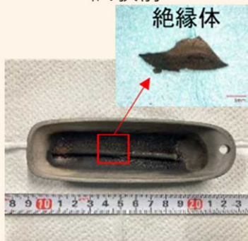
試験後 (1000°C水素ガス環境下)
