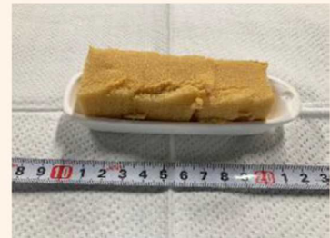
試験後 (200°C水素ガス環境下)
