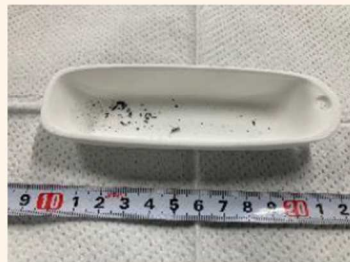
試験後 (1000°C水蒸気環境下)
