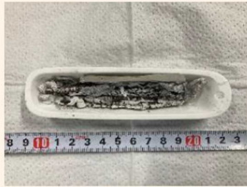
試験後 (1000°C水蒸気環境下)
