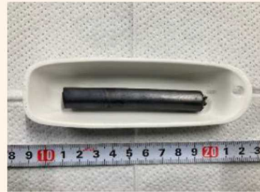
試験後 (200°C水蒸気環境下)
