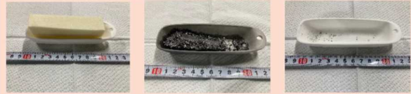
試験前 試験後 (1000°C水素ガス環境下) 試験後 (1000°C水蒸気環境下)
