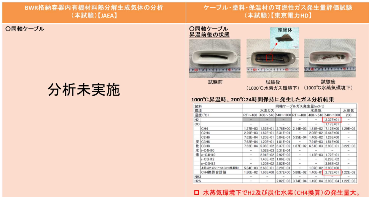
図 29-4 同軸ケーブルの結果概要
