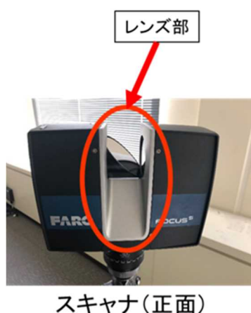
図4 3Dレーザースキャナのレンズ部
