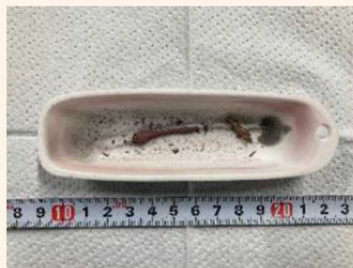
試験後 (1000°C水蒸気環境下)
