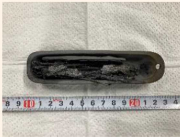
試験後 (1000°C水素ガス環境下)
