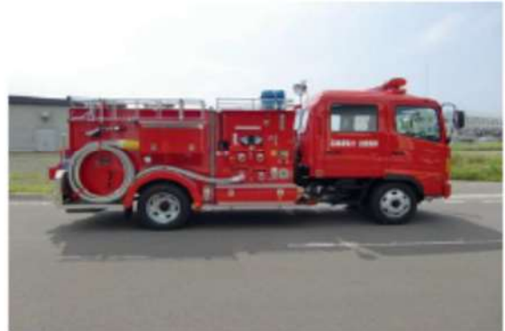
第2図：水槽付消防ポンプ自動車
