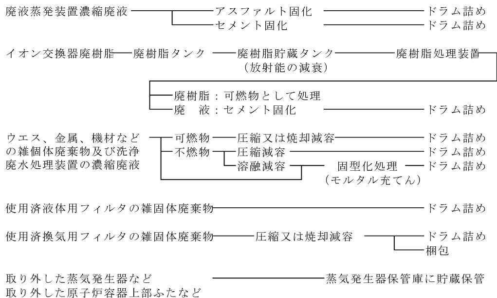
固体廃棄物設備は、廃棄物の圧縮、焼却、固化などの処理を行う過程において放射性物質が飛散しないような措置を講じている。また、この設備からの排ガスはフィルタを通して、モニタによって監視しながら排気筒より放出する。
