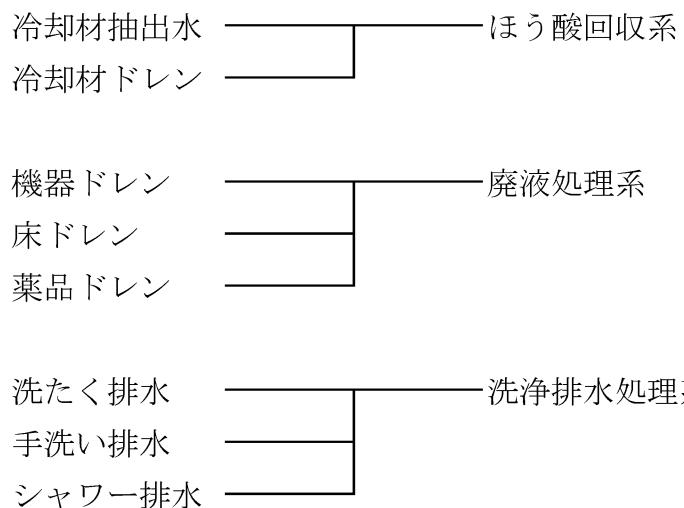
液体廃棄物処理設備により処理した後の処理水は、試料採取、分析（放射性物質濃度、化学分析）を行い、再使用するか又は放射性物質濃度が十分に低いことを確認したうえで、モニタによって監視しながら復水器冷却水と混合、希釈して放出する。
