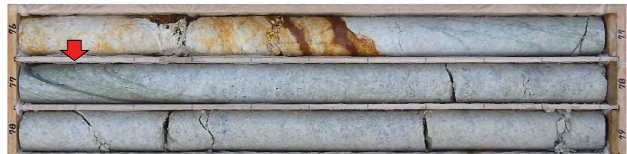
M1-13孔 77.1m付近 粘土状破碎部(N22E/68W)
