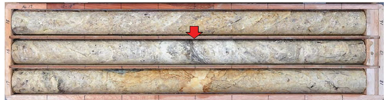
No.17孔 16.5m付近 粘土状破碎部(N14W/60W)
