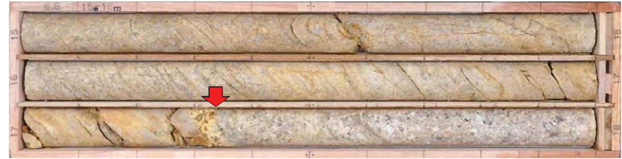
No.6孔 17.3m付近 礫混じり砂状破砕部 (N40E/68SE)
