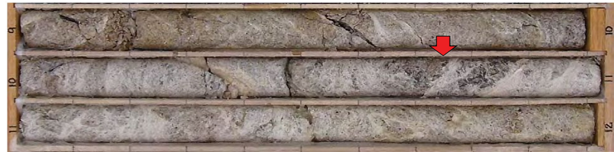
M1-14孔 10.75m付近 粘土状破碎部(N19E/75W)
