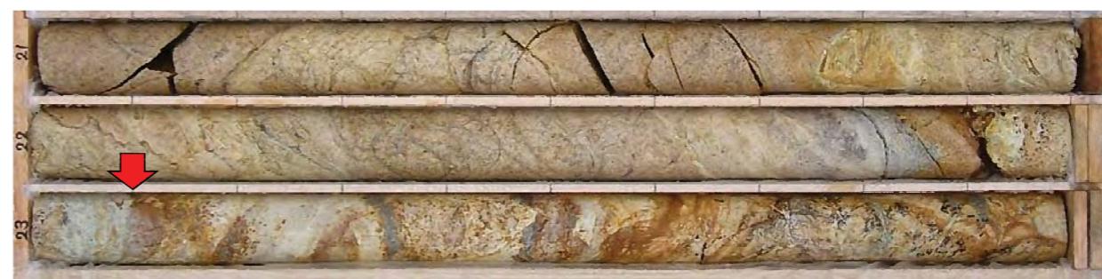
M1-13孔 23.1m付近 粘土混じり角礫状破碎部 (N23E/63E)
