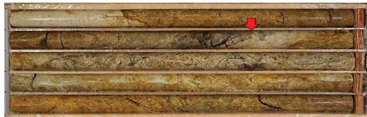
M1-10孔 66.7m付近 礫混じり粘土状破碎部 (N24E/73E)
