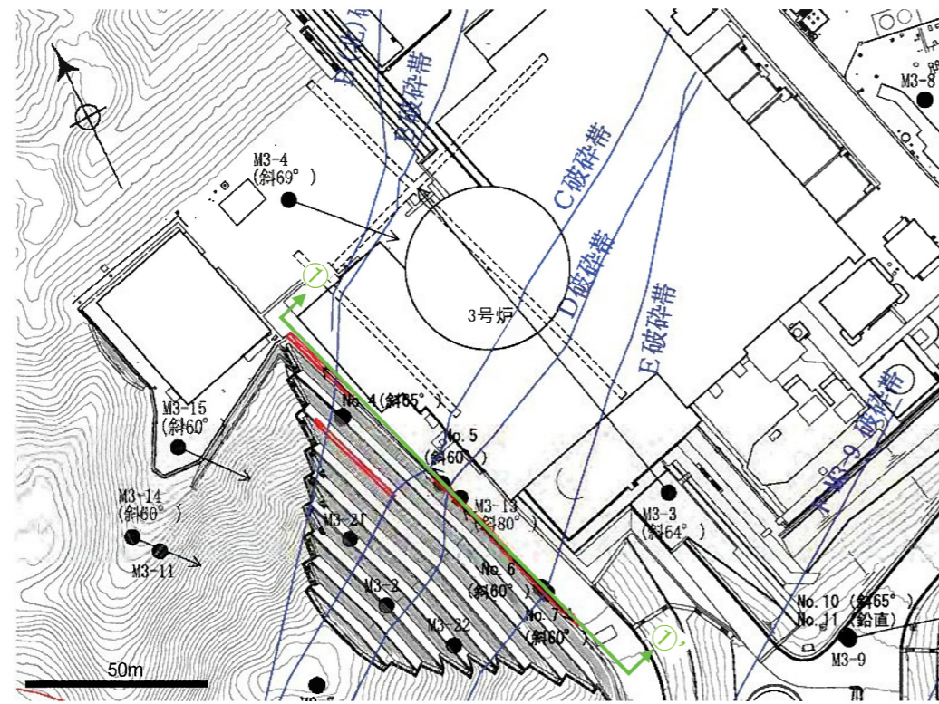
断面位置図 E.L.+0mにおける破碎帯の分布を表示
