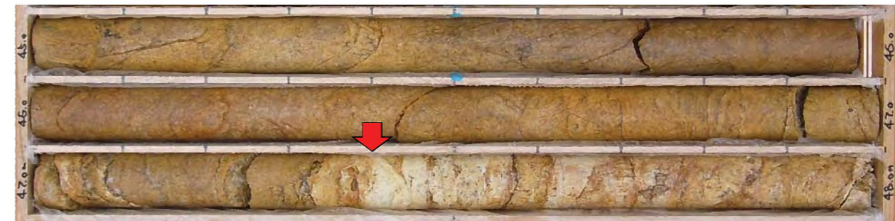
M3-13孔 47.4m付近 固結した砂状破碎部 (N78E/58SE)
