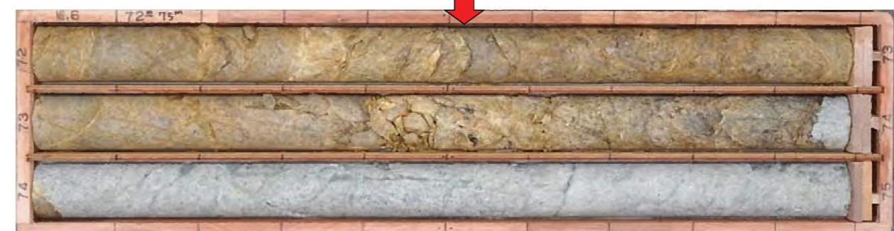
No.6孔 72.5m付近 固結した角礫状破碎部 (N35E/60SE)
