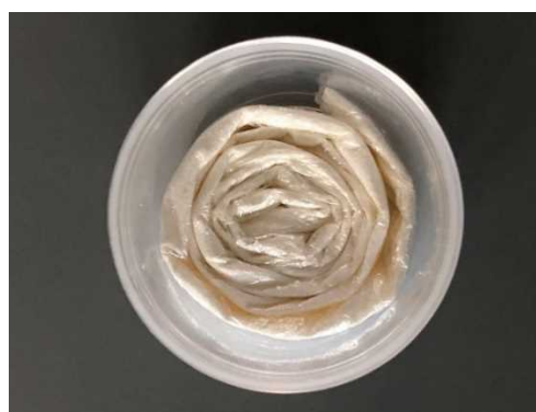
写真 2-7 6時間分に切り取った長尺ろ紙を充填した例 (集じん面が底に近づくよう細長く折ってロール状に小型容器に充填した例)
