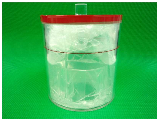
写真 2-11 ビニールテープによる蓋の固定
