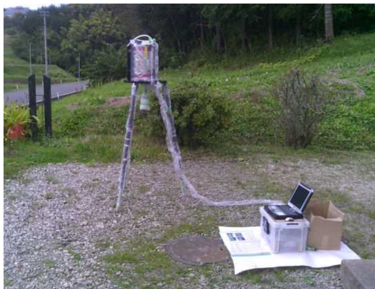
図B-1 液体窒素冷却式in-situ測定用ゲルマニウム半導体検出器の例
