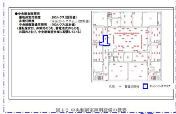
図4-2 中央制御室照明設備の概要
