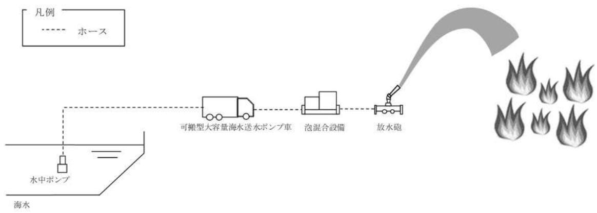
第 4.3.3 図 発電所外への放射性物質の拡散を抑制するための設備
