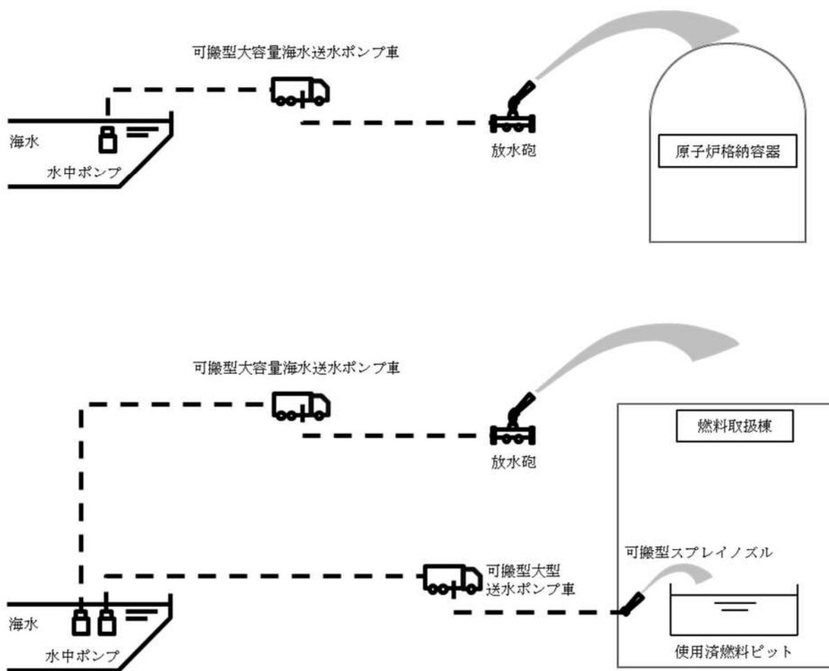
第4.3.1図 発電所外への放射性物質の拡散を抑制するための設備
