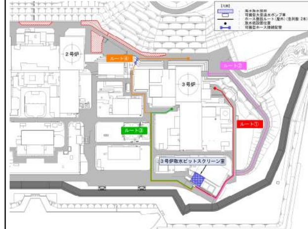
第5図 ホース敷設ルート（放射性物質拡散抑制）(1/2)
