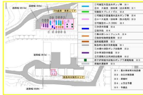
第2図 保管場所の可搬型設備配置(1/3)
