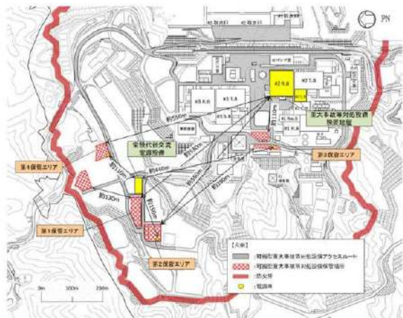
第3-2図 保管場所からの離隔距離（原子炉建屋、常設代替交流電源設備）
