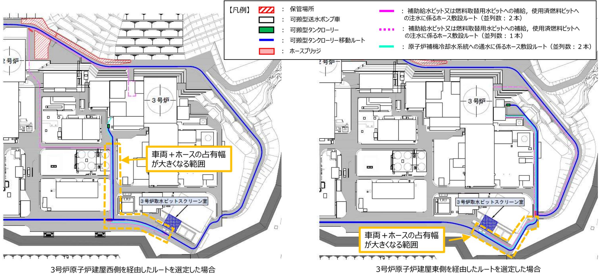
**図3 可搬型タンクローリー通行時のホース敷設状況**
