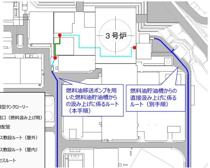
図4 ディーゼル発電機燃料油移送ポンプ及び可搬型タンクローリーを用いた燃料補給のルート概略図
