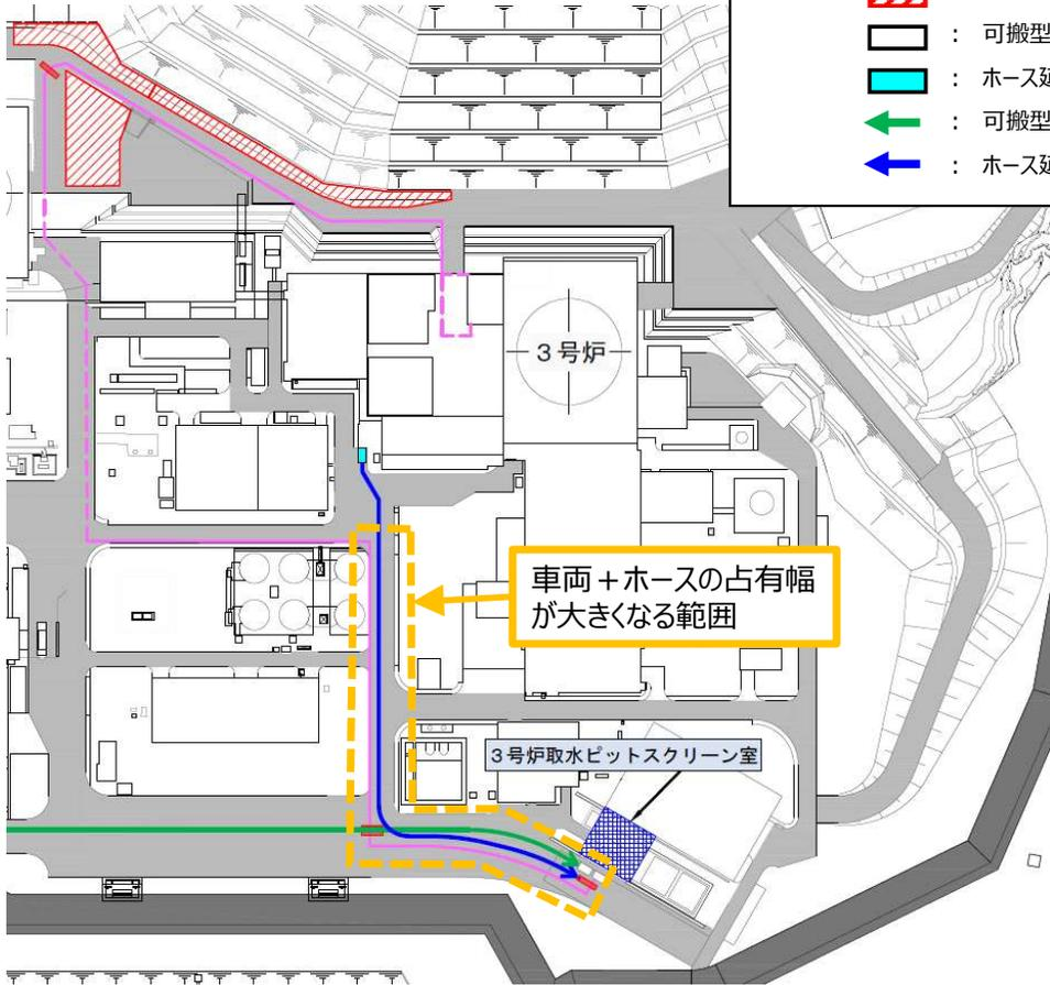
3号炉原子炉建屋西側を経由したルートを選定した場合
