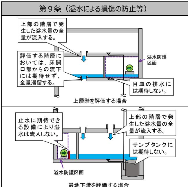
図2 第9条における溢水水位評価概要図
