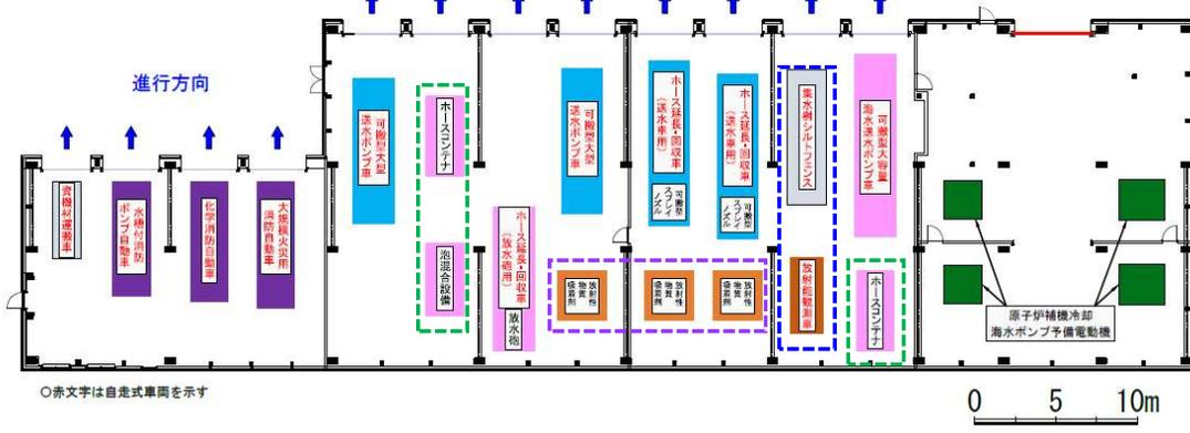
図2 51m倉庫・車庫内の設備配置の見直し
