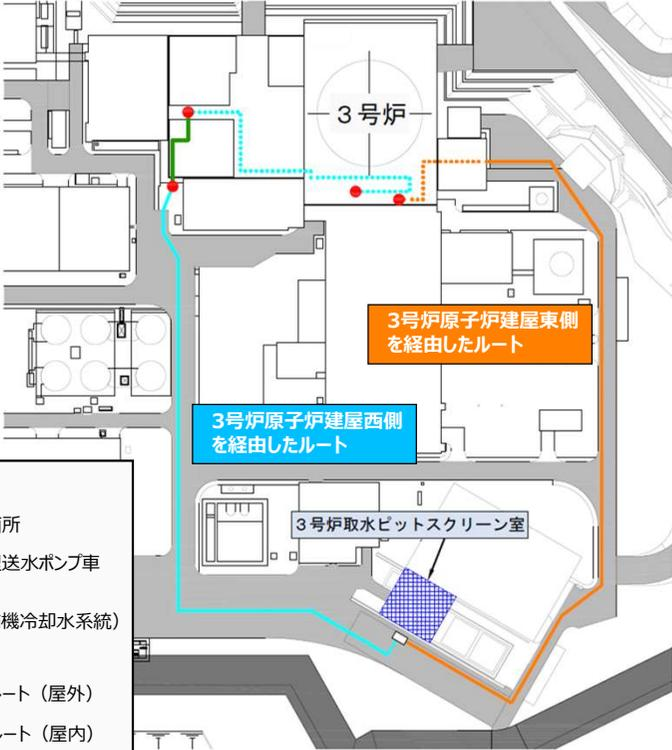
図2 原子炉補機冷却水系統への通水確保（海水）の概略図
