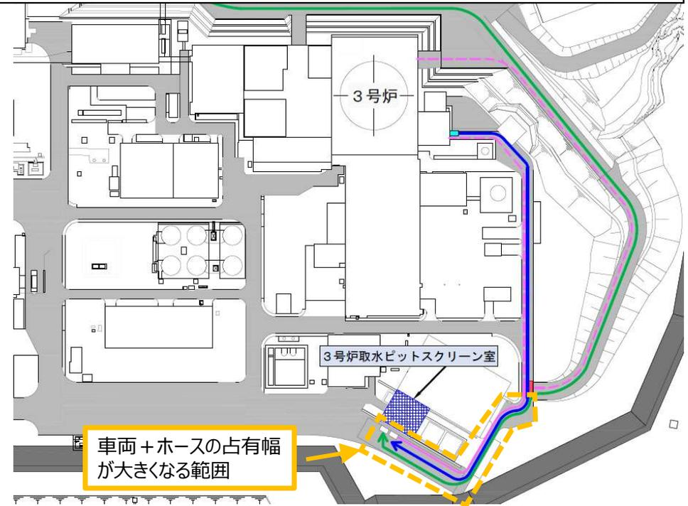
3号炉原子炉建屋東側を経由したルートを選定した場合
