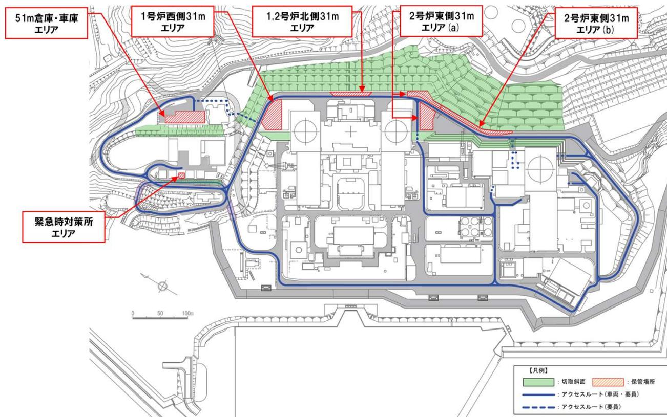
図 保管場所の周辺斜面及び敷地下斜面位置図
