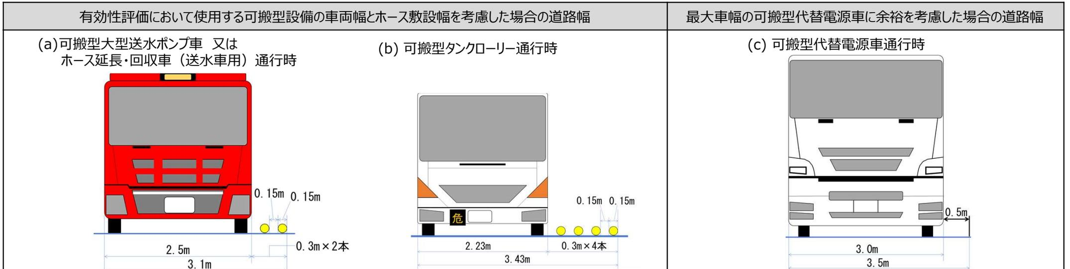
図1 可搬型設備の通行に必要な道路幅の考え方
