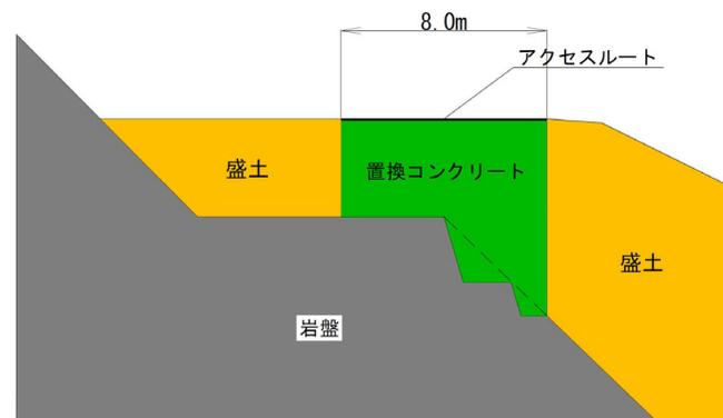
図 置換コンクリート概略断面(A-A'断面)
