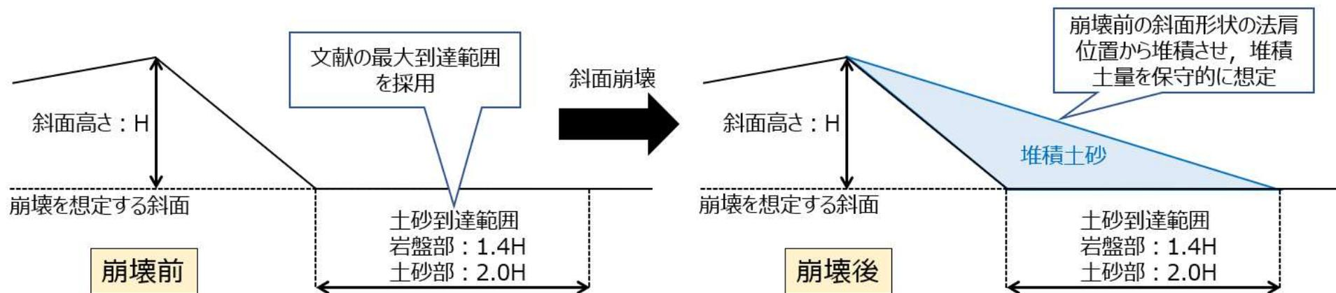
図 周辺斜面の崩壊範囲概略図
