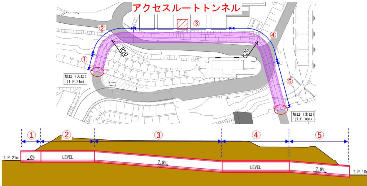
図1 アクセスルートトンネル平面図及び縦断面図
