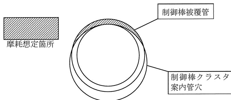
図3.14.5-1 玄海3号炉 制御棒被覆管想定摩耗形状
