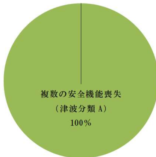
第 3.2.2. d-3 図 事故シーケンスグループごとの全炉心損傷頻度への寄与割合
