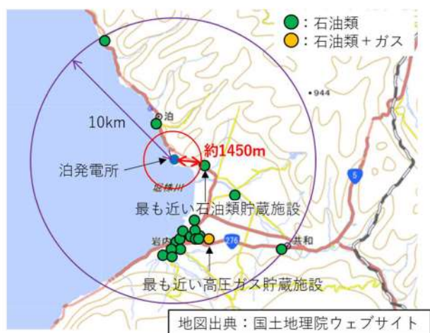
図 3-2 発電所から 10km 圏内に位置する危険物貯蔵施設等
