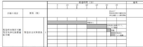
第1.18.4図 緊急時対策所非常用空気浄化装置運転 タイムチャート
