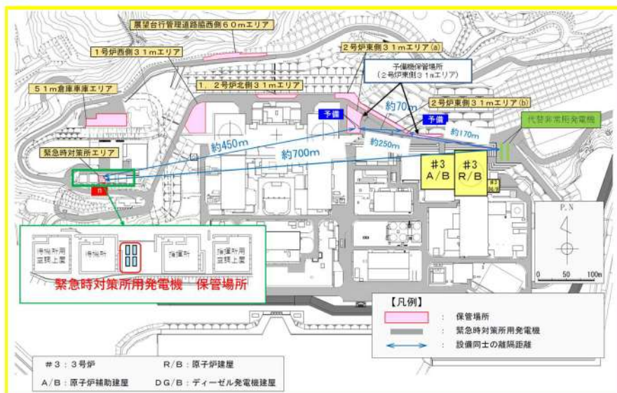
図4-10 緊急時対策所用発電機の保管場所
