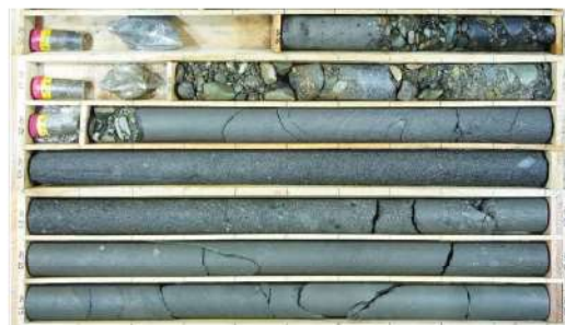
添付 1-38 図(3/3) ボーリング柱状図・コア写真 (SW2-4)
