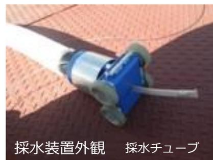
2. RCW-Hx(A),(B),(C),RCWポンプ出口ヘッダ配管内包水のサンプルングに際して、マニフォールドプレートの小口径(Φ16mm)の穴に採水ホース(Φ12mm)を通していく。なお、RCW-Hxの下部まで通せる穴は一行のみ。
