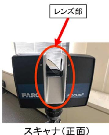
図4 3Dレーザースキャナのレンズ部
