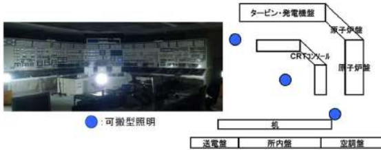
図4-4 シミュレータにおける可搬型照明（SA）確認状況
