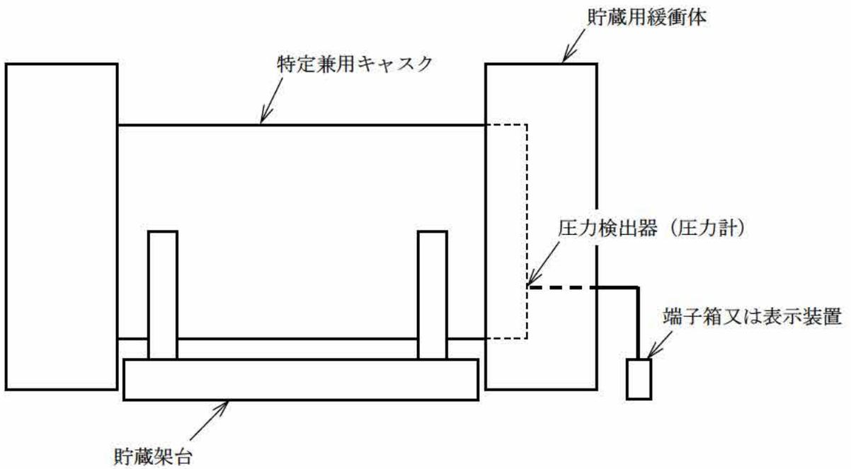
図 4 圧力監視装置の構成図
