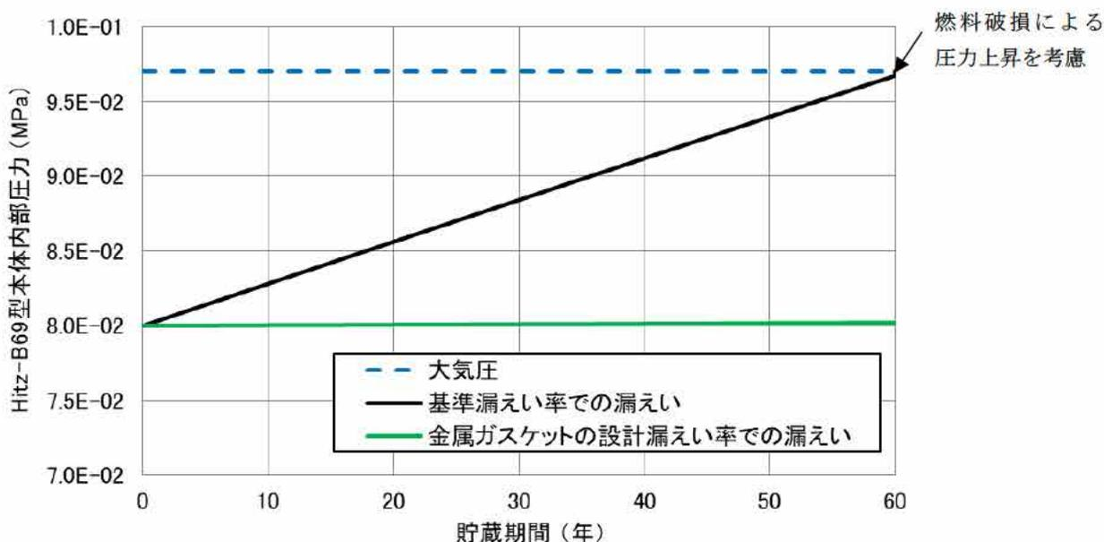
図7 Hitz-B69型本体内部圧力の経時変化
