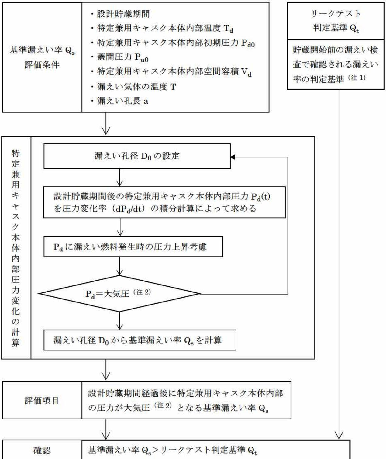
(注1) 貯蔵前の漏えい検査において、一次蓋、ドレンバルブカバー部及びベントバルブカバー部の3か所の漏えい率の合計値がリークテスト判定基準以下であることを確認する
