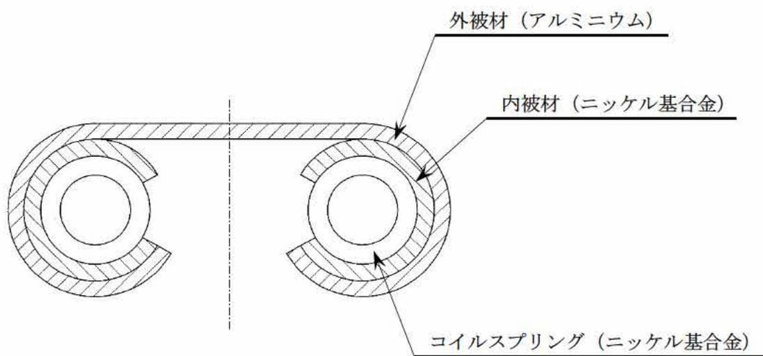
図3 金属ガスケット構造 (ばね入りメタルCリング、眼鏡型)
