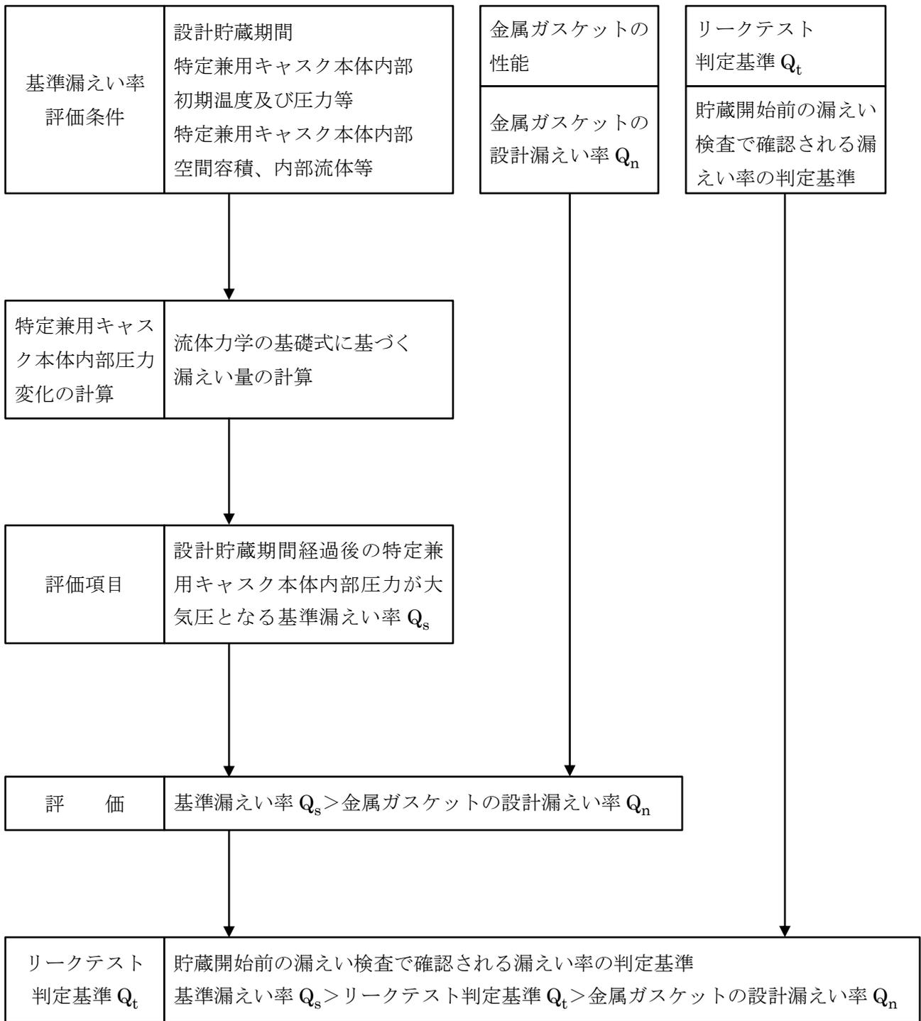
図 6 閉じ込め評価フロー図
