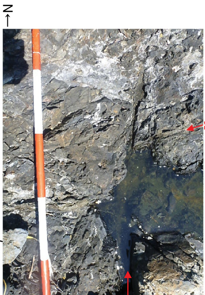
No.1 (頁岩中の破砕帯) F1 (N13E80W) がF2 (N81W76S) と 頁岩(白色化部)を23cm程度左横ずれ させている。
