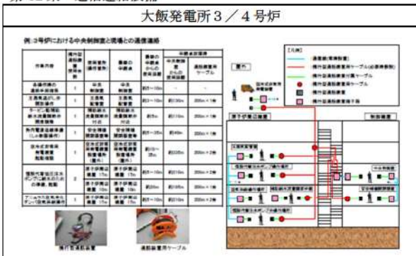
図 5 3号炉における中央制御室と現場との通信連絡概要図
