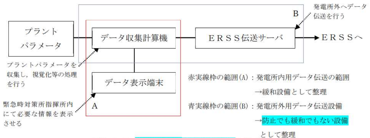
図 2.5-2 緊急時対策所情報収集設備の概要
