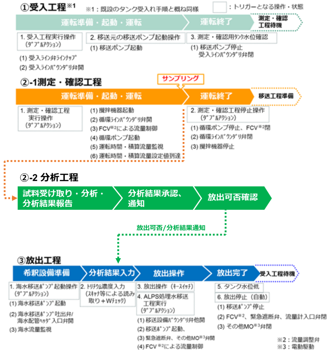
図 1.1.5-3 受入，測定・確認，放出工程の手順
